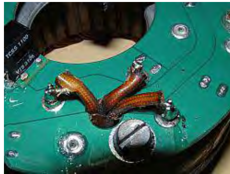
Abbildung 3.b Anlöten der drei Statorphasen
