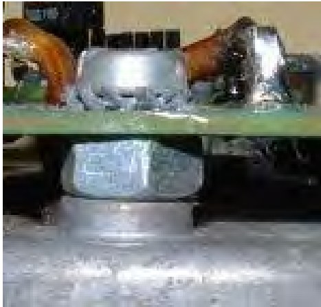
Abbildung 3.a M6-Mutter als Distanzstück
