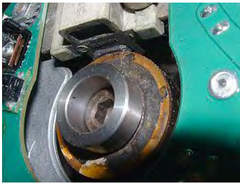
Abbildung 7 Montage des Stators und Mitnehmers.
