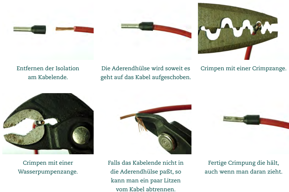
Abbildung 11 Crimpen der Aderendhülsen
