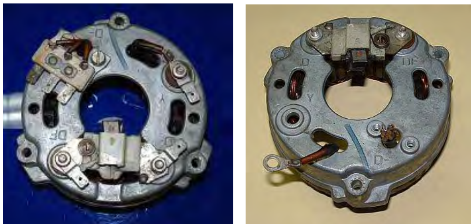
Abbildung 2 Entfernen des Anschlussblocks und der Y-Verbindung
